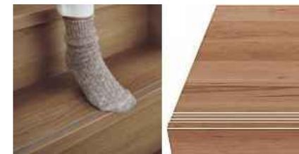
踏み板は独自の凸凹加工を施した防滑シート。前部にはすべり止めU溝加工、端部は万一足が当たっても怪我をしにくいR面取り加工です。
