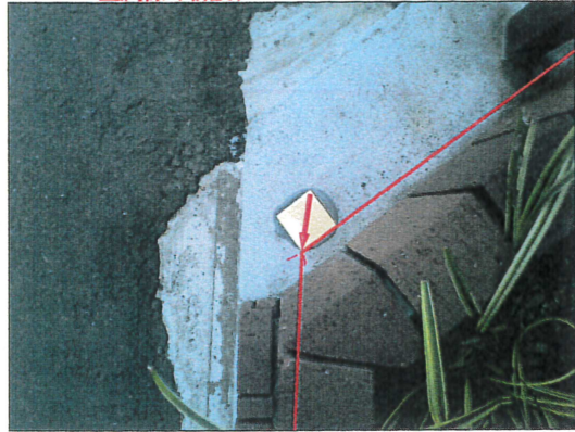
SK2 金属標(新設)
